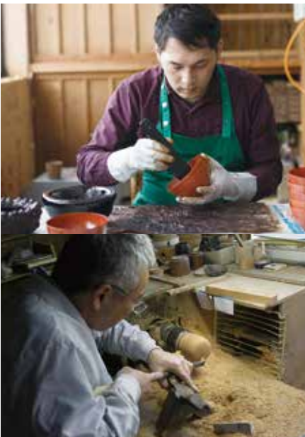
上／山中漆器に特筆すべき「拭き漆」の技法。 下／ろくろを使って成型する「挽物木地」。熟練の技術がなければ美しい木目が現れないのだとか。
