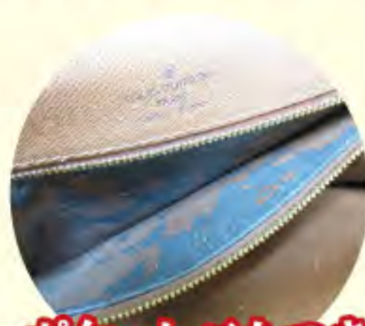
ポケットべたつき 劣化
